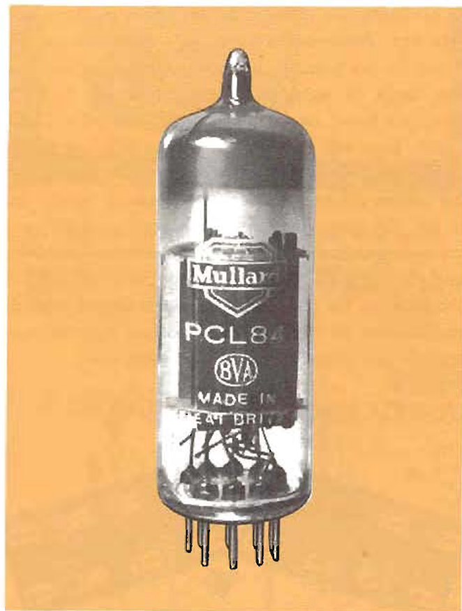
Una válvula de radio es un dispositivo gracias al cual se regula la migración de electrones en dirección e intensidad.
