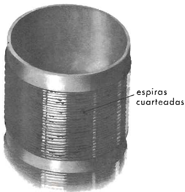
Las espiras con el esmalte cortado restan efectividad a las bobinas.
