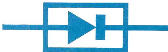
Símbolo del detector. La corriente puede atravesarlo según el sentido que indica la flecha.
