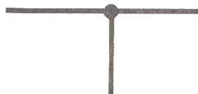
CONEXION DE CONDUCTORES
