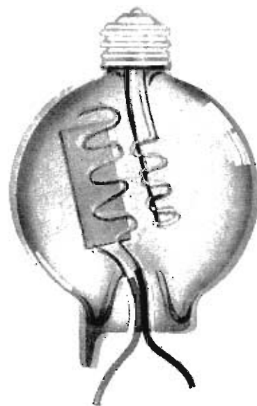
Aspecto de una antigua válvula triodo, contemporánea de la que ideó De Forest.
