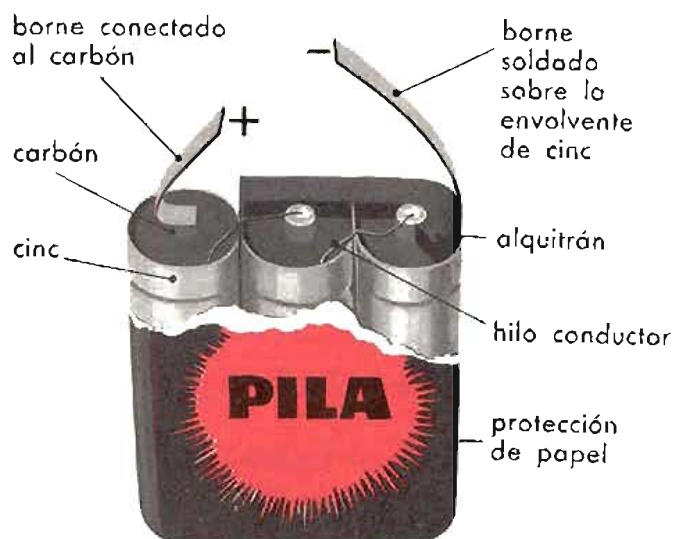
Disposición de los elementos de una pila seca de 4.5 V. Se trata de la asociación en serie de tres pilas de 1.5 V.
