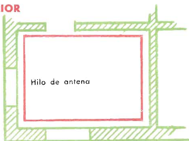
La longitud del hilo de la antena deberá cubrir todo el perímetro de la habitación.
